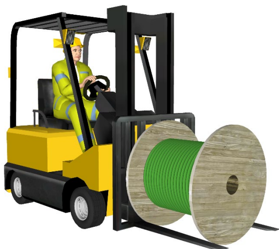
Figur 2 Gaflene må være lange nok til å holde begge vangene.
