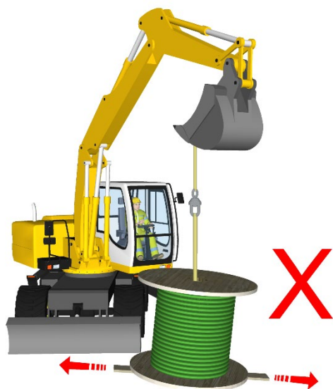
Figur 8 Trommel skal ikke henge i svivel da dette kan føre til uønskede situasjoner.
